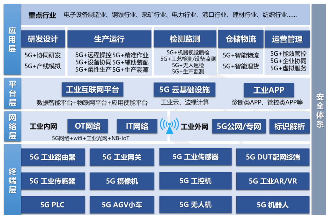
图 1 5G+工业互联网架构
